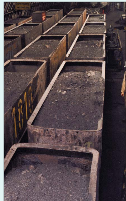
Mit Rohkohlen beladene Förderwagen im Füllort unter Tage
